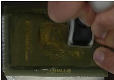
Drücken Sie nun den befeuchteten Signierstempel im 90° Winkel auf, halten Sie mit der anderen Hand die Schablone gut fest oder fixieren Sie diese gut, da mit dem Signierstempel ein etwas festerer Druck ausgeübt werden muss. Gehen Sie nun mehrmals in kreisenden Bewegungen über das Werkstück.
