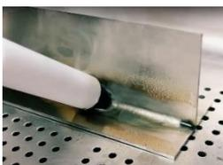
Setzen Sie den Pinsel auf das Werkstück auf und fangen Sie mit dem Reinigen an. Dafür üben sie einen leichten, konstanten Druck auf der zu reinigen Stelle aus. Bewegen Sie den Pinsel hin und her. Drücke sie nicht zu Hart auf den Pinsel. Sorgen sie dafür, dass die maximale Auflagefläche des Pinsels auf das Werkstück trifft, dies sorgt für eine besser Reinigungseffektivität.
