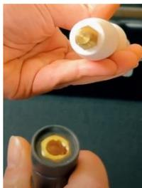
Nachdem Sie das Gewinde des Pinsels nun mit der Kupferpaste versehen haben, schrauben Sie diesen auf dem Handgriff auf. Nun können Sie den Pinsel mit Handgriff am Arbeitskabel anbringen. Hierzu den Bajonettverschluss wieder gut festziehen.
