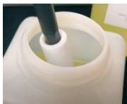
Nun können Sie mit dem Reinigen starten. Tauchen Sie den Pinsel in das Elektrolyt und lassen Sie ihn abtropfen.
