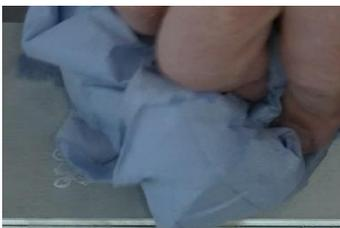
Nach Fertigung des Prozesses, entfernen Sie die Schablone und besprühen die Signierte Stelle mit Neutralyt oder Demineralisierten Wasser. Wischen sie die Stelle mit einem Papiertuch trocken.
