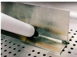
Der Pinsel sollte während des Prozesses nicht austrocknen, tunken Sie ihn immer wieder erneut in das Elektrolyt wie oben beschrieben. Rühren sie den Pinsel im Behälter ein bisschen, um gelöste Oxide von der Kohlefaser zu entfernen und den Pinsel zu kühlen, um somit die Abnutzung zu verringern.
