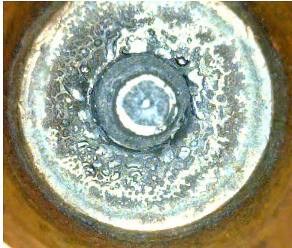
Abb. 64 – Asymmetrischer Einbrand mit ungleichmäßigem Rand und raue Oberfläche an der Vorderseite der Elektrode
